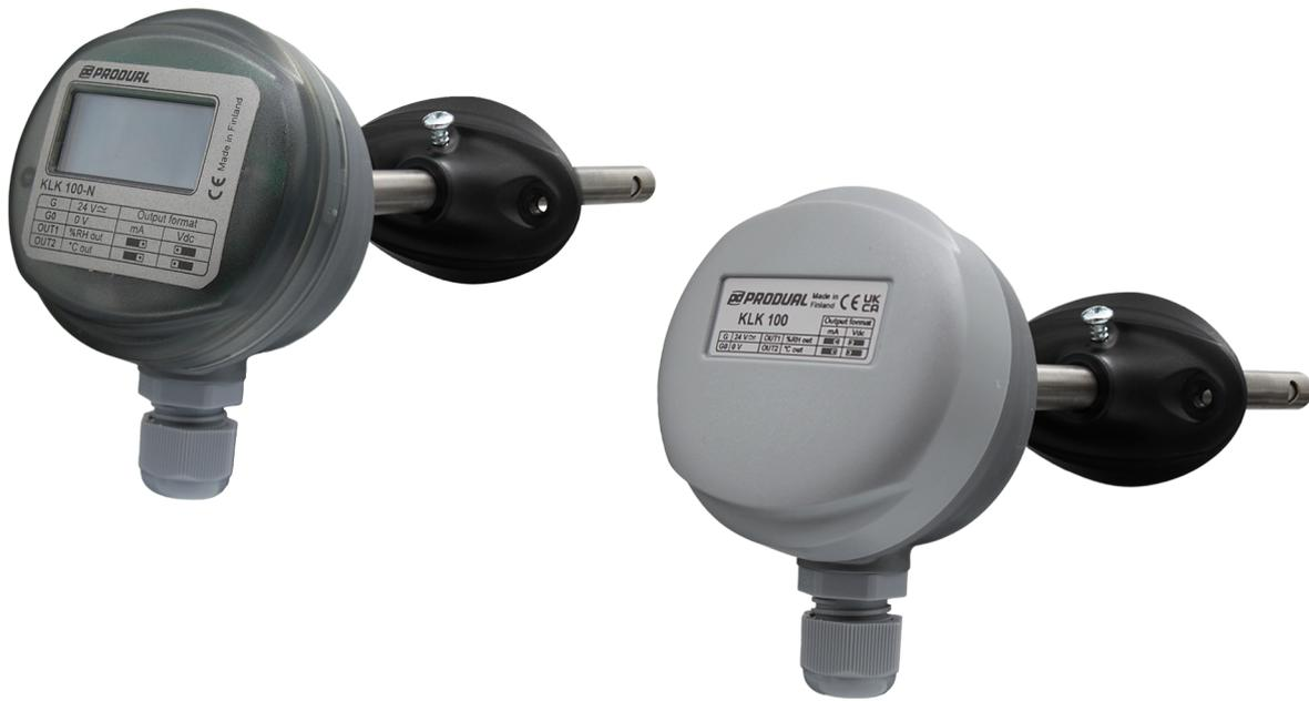
Les capteurs d'humidité pour conduit KLK mesurent l'humidité relative et la température à l'intérieur des conduits de ventilation. Ils sont conçus pour les applications à humidité faible et élevée dans les environnements sans condensation. Ces capteurs offrent une large plage de mesure de l'humidité et de la température. Vous pouvez définir une plage de mesure personnalisée (limite basse et limite haute) séparément pour la mesure de l'humidité et de la température.
